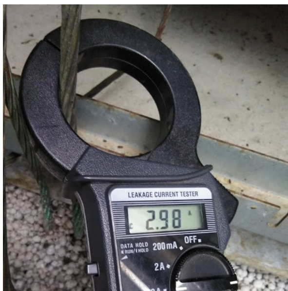
Illustration 3: Første måling viser lækstrøm fra et af fire jordingskabler i en 900KW vindmølle. Bemærk dog at ståltårnet er boltet til et jordforbundet fundament med ca 50 bolte. Hvis der således løber en tilsvarende strøm i hver eneste jordforbindelse, er den samlede afledning til jord ganske formidabel. Næste måling (på 9,38 Ampere) viser lækstrøm fra en transformator. Måling lavet i samarbejde med Vagn Larsen, Feltfri.dk
