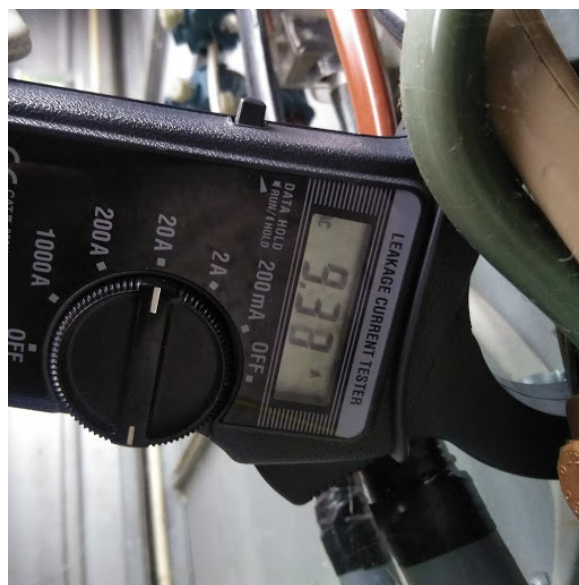
Illustration 3: Første måling viser lækstrøm fra et af fire jordingskabler i en 900KW vindmølle. Bemærk dog at ståltårnet er boltet til et jordforbundet fundament med ca 50 bolte. Hvis der således løber en tilsvarende strøm i hver eneste jordforbindelse, er den samlede afledning til jord ganske formidabel. Næste måling (på 9,38 Ampere) viser lækstrøm fra en transformator. Måling lavet i samarbejde med Vagn Larsen, Feltfri.dk
